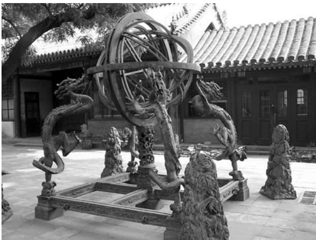
Figure 1. Sphère armillaire, instrument de mesure des positions des astres.
