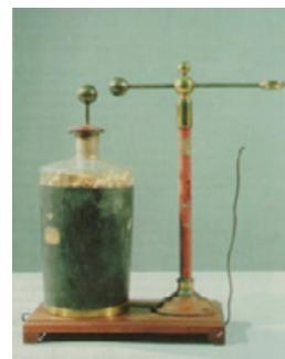
**Figure 4.** La bouteille électrométrique de Lane. L'armature externe de la bouteille de Leyde est reliée à une électrode horizontale graduée qui glisse sur une colonne. La longueur de l'étincelle qui éclate entre la sphère de l'électrode et celle de la tige, en communication avec l'armature interne de la bouteille, permet ainsi d'estimer la quantité d'électricité accumulée. Cet électromètre fut proposé par Timothy Lane en 1766 [6,7].
